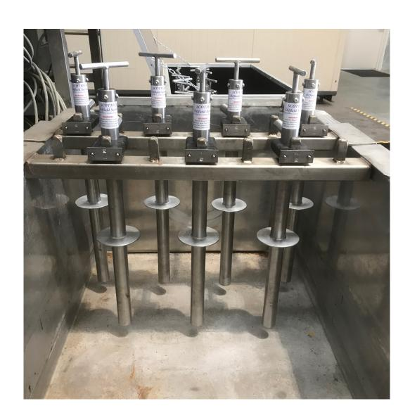
El Sistema de Eliminación de Virutas Magnéticas está diseñada para eliminar las virutas del fluido circulante durante la operación de fresado de revestimiento w al fresar longitudes cortas, típicas de menos de 60 metros
