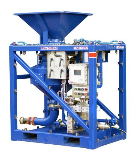
La unidad de soplado de esquejes es utilizada para el transporte a granel de cortes de perforación y otros materiales. El soplado de esquejes es un depósito a presión, puede transportar esquejes a velocidades de hasta 25 toneladas por hora.
