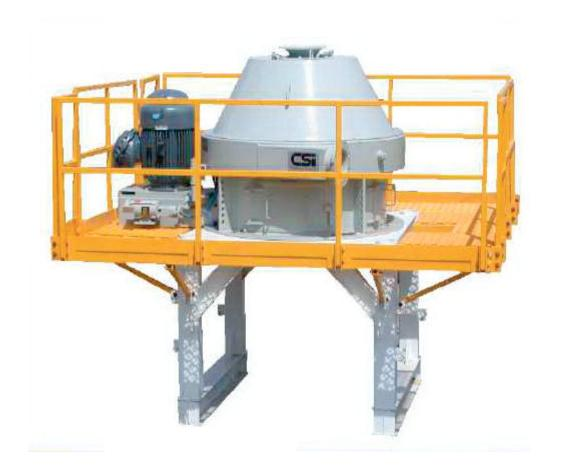
El Secador de Cortes Verticales CSI™WSM-04 es una centrifugadora de pantalla vertical, para la separación continua de líquidos y sólidos. Los datos de rendimiento de la muestra revelan que el VCD puede lograr una reducción del 65% de la descarga de fluidos, con descartes que oscilan entre el 6% y el 4% de petróleo, por peso. El VCD puede recuperar hasta el 90% de los fluidos de perforación de los cortes.
